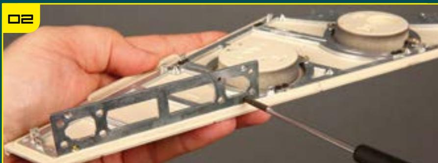
02 Зафиксируйте раму SF-09, закрутив винты в отверстия в опорных пластинах, отмеченных на шаге 01.
