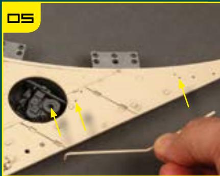
Вклейте два штифта детали 4 в отмеченные отверстия, а изогнутый конец — в основание ниши.
