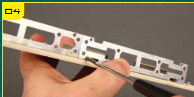
04 Зафиксируйте раму SF-08, закрутив винты в отверстия в опорных пластинах.
