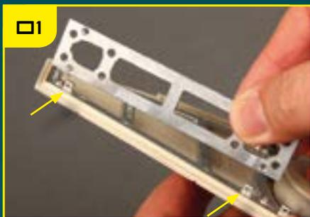
01 Возьмите раму SF-09 и установите ее на нижней части «жвала» так, чтобы отверстия совпали.
